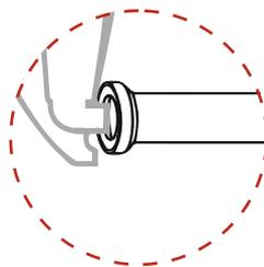
Betrieb nur mit zugelassenem Anschlussstutzen (Artikel-Nr. T8009)
